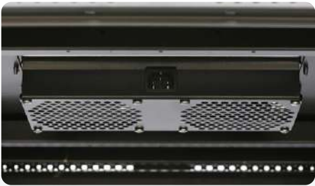
顶置风扇 Over head fan
